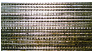
◀ Блок детектора ATLAS, получаемый диффузионной сваркой
